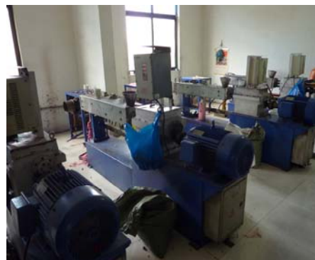
写 26 実験室の押出機
