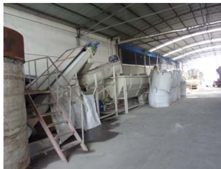
写 20 再生フレーク生産ライン
